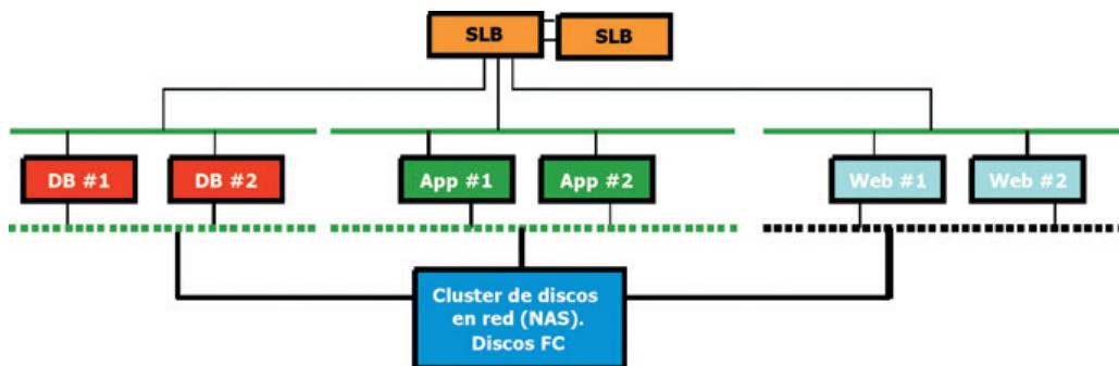
En esta arquitectura se presupone que todos los elementos se encuentran redundados, y que todos los servicios fundamentales del sistema, se ejecutan en al menos dos equipos. En este escenario, la caída de un equipo es detectada por el balanceador, el cual redirige todo el tráfico TCP al nodo activo.
