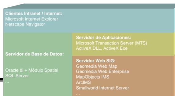
Las peticiones de información por parte de los clientes se realizarán al Servidor Web a través del servicio "http" de Internet. El Servidor Web será el encargado de ejecutar la página ASP solicitada, accediendo entonces al Servidor de Aplicaciones y al Servidor Web SIG. Como resultado, devolverá al cliente una página en formato HTML/DHTML para su interpretación por parte del navegador local. En el siguiente gráfico se
